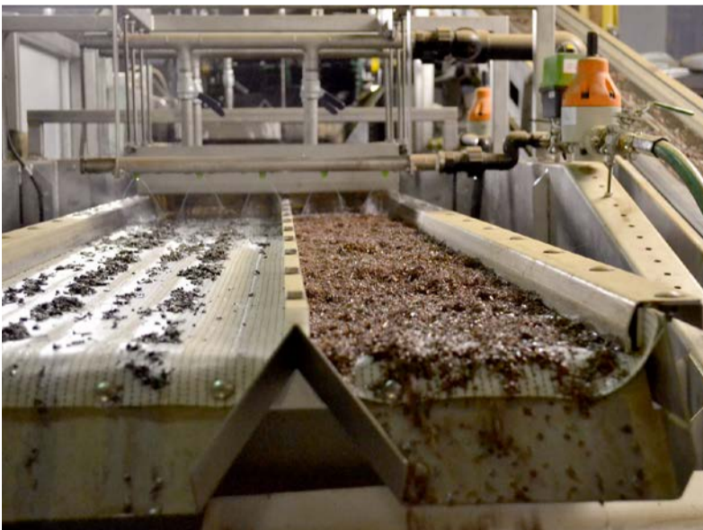
Het gesorteerde materiaal, zink (links) en de fractie koperrijk, komt uit de MDS-productielijn.
